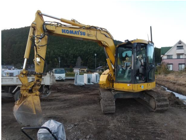
ICT 機器を搭載したバックホウ
