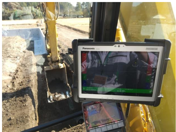
バケットの位置がパッドに表示される
