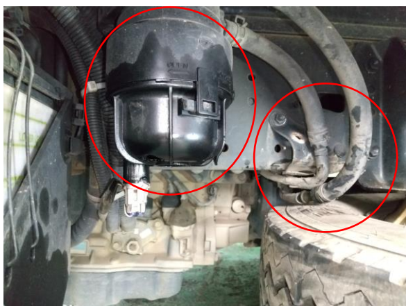
燃料フィルタが損傷し、燃料が供給されなくなり、走行不能となった。
