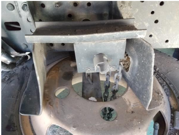
スペアタイヤ取付金具が著しく変形。
