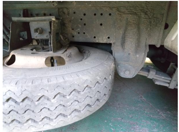
スペアタイヤが押し出されサスに接触。
