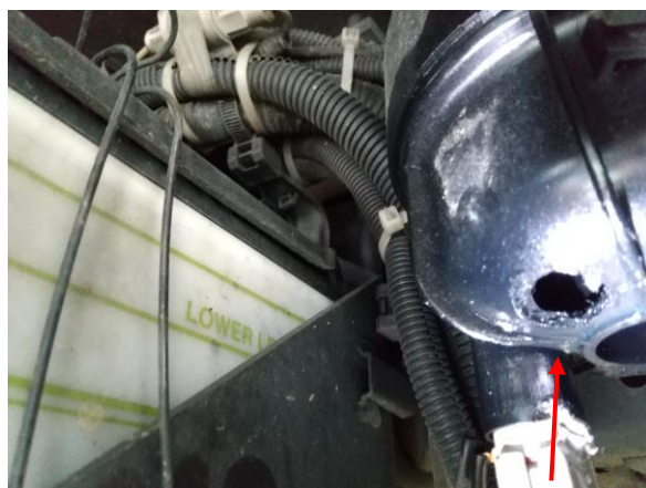
燃料フィルタが損傷し、燃料が供給されなくなり、走行不能となった。
