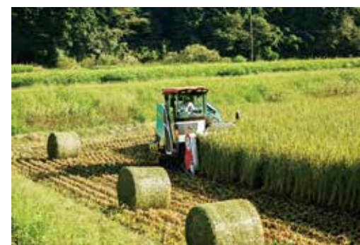
収穫した飼料用イネは細断後、乳酸菌が自動噴霧され混合。高密度に圧縮・梱包し排出される。
