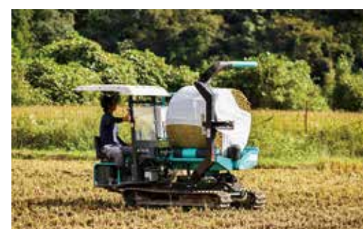
排出されたロール状の稲は専用のフィルムで包み込み、密封。フィルムの中で乳酸発酵し、長期保存可能な飼料となる。
