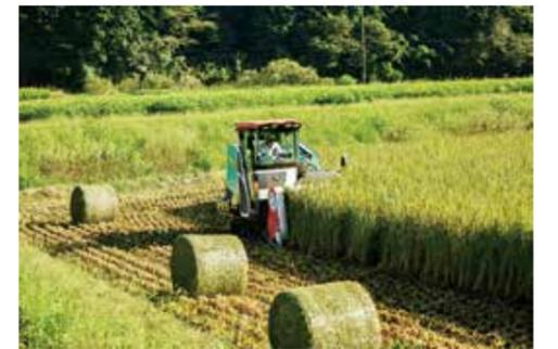
収穫した飼料用イネは細断後、乳酸菌が自動噴霧され混合。高密度に圧縮・梱包し排出される。
