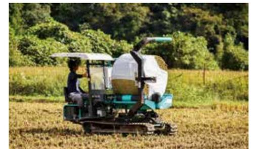
排出されたロール状の稲は専用のフィルムで包み込み、密封。フィルムの中で乳酸発酵し、長期保存可能な飼料となる。
