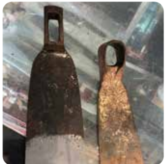
鍬の柄を入れる部分の形状。右が「巻きびつ」といわれる伊予型。左が「抜きびつ」といわれる土佐型。強靱な地盤の土佐では、より頑丈な作りが求められた。
