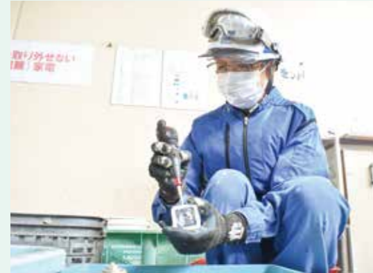
▲精密ドライバーや電動ドライバーを使って、リモコンやおもちゃに入っている電池を取り出す今井さん。
